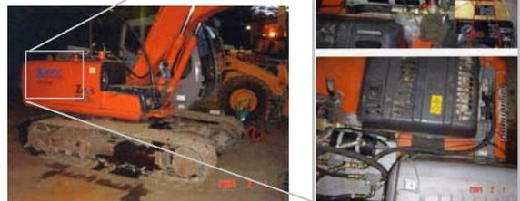
作動油中の気泡を除去することで、キャビテーションの発生量が低減し、機器部材の壊食量が低減した。見かけの体積弾性係数が大きくなり、油の温度上昇や酸化劣化時間が抑制され、長寿命化が実現された。
