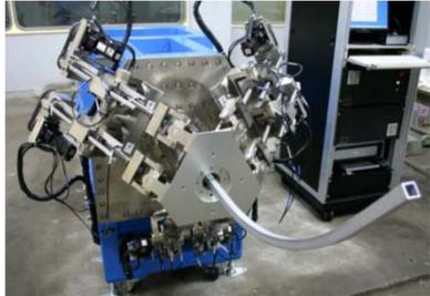
プロジェクトでは、パラレルメカニズムを曲げ加工機に用い、プラットフォーム上のダイス姿勢を自由自在に変化させ、パイプを自由に曲げられる加工機を開発した。
