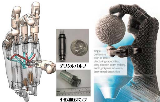
図1 油圧駆動小形ロボットハンド
